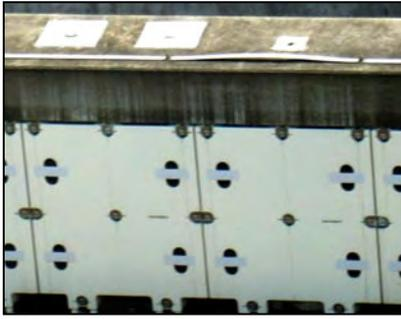
図3 軌道両側に設置の地上コイル
