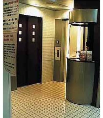
最後は無人の有料トイレ。京都 JR 嵯峨野線二条城駅前の全自動トイレ。パリの有料トイレと同じ方式、便座固定式。100円挿入でドアが開き、10分間の使用時間。1分前に警告がされ、10分間の延長が1回だけ許される。使用后、ドアが閉じると同時に室内が自動洗浄される。このトイレ、韓国製で1ヶ月35万円での借用という。
