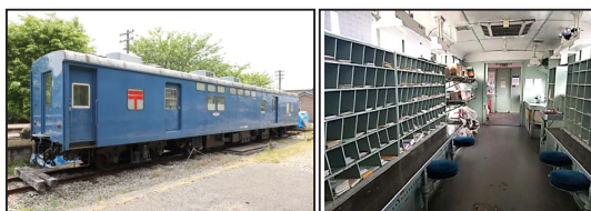
のと鉄道能登中島駅に保存される鉄道郵便車オコ 10形式と車内の区分け作業室、収納空間
