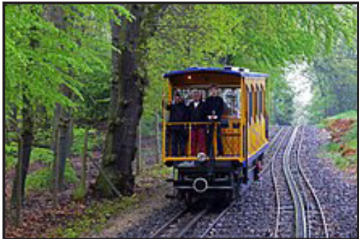
ラックアンドピニオンブレーキ付き ウォーターバラスト鉄道
